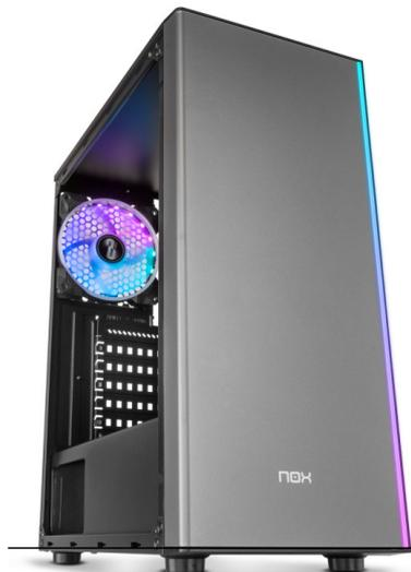
**INFINITY OMEGA ARGB MID TOWER CHASSIS** Panel lateral acrílico Iluminación y control ARGB Dos entradas USB 2.0, una 3.0 y audio HUB. 1 ventilador ARGB de 120 mm incluido Posibilidad de instalar hasta 4 ventiladores **DISEÑO CON PANEL ACRÍLICO**
