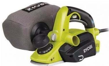
**Especificaciones** Potencia: 600 W. Velocidad máxima: 16 000 rpm. Profundidad de cepillado: 1.5 mm. Anchura de corte: 82 mm. Base delantera de fundición de aluminio moldeada a presión con ranura de 0,5mm para el achaflanado. Botón para seleccionar la expulsión de la viruta hacia la derecha o hacia la izquierda. Portacuchilla automático para evitar dañar la pieza trabajada cuando no se utiliza el cepillo. Peso: 3.1 kg.
