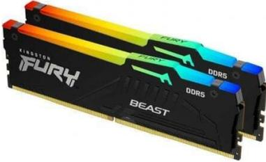
**Especificaciones** Capacidad: 32 GB ( 2 x 16GB) Tipo: DDR5 Frecuencias 6000 MT/s Latencias CL30 Tensión 1.4 V PIN: 288-Pin Temperatura de servicio 0 °C a 85 °C
